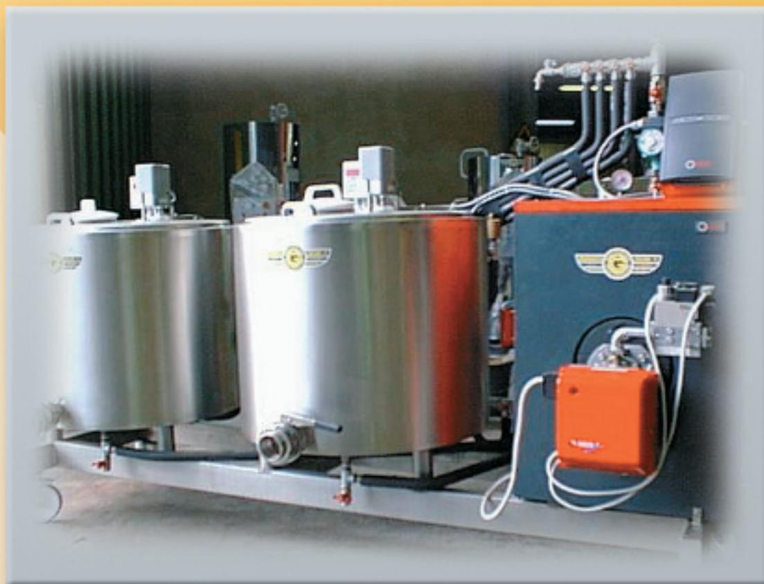
Mini caseificio premontato con funzionamento ad acqua calda.
