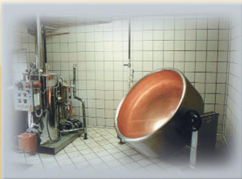
Doppiofondo coibentato in rame ed acciaio rovesciabile su movimento per formaggio e ricotta, e caldaia a vapore completamente esonerata da patentato.
