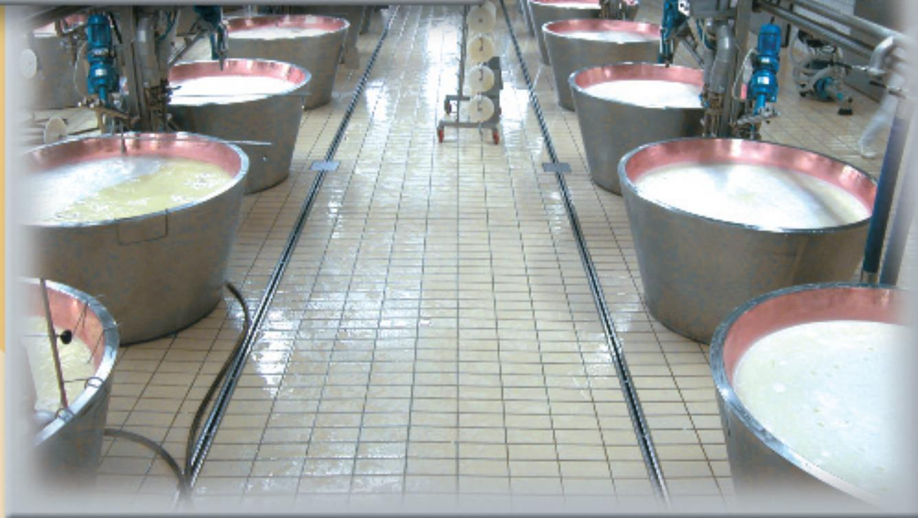
Impianto per produzione parmigiano reggiano e grana padano con doppiofondi isolati brevettati con sistema automatico di dosatura latte, siero innesto, e caglio.
