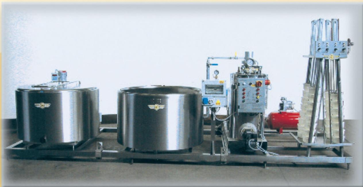
Mini caseificio premontato su basamento con funzionamento a vapore per formaggi pressati.
